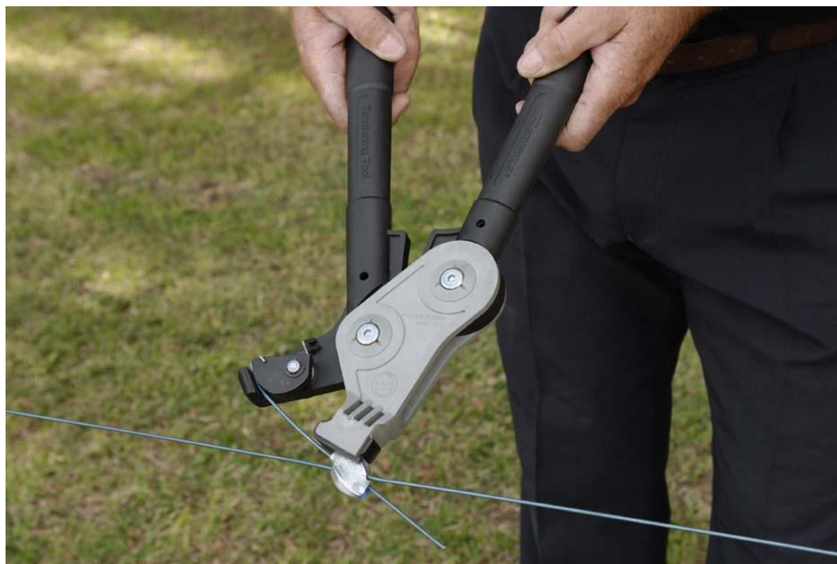
Рис. 7. Соединение и натяжение проволоки.
