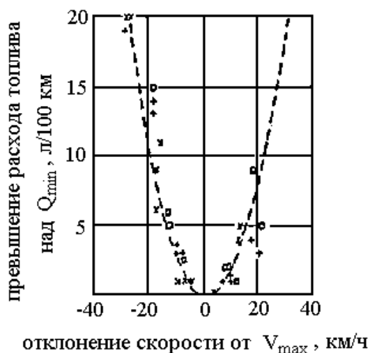
Рисунок 6 – Зависимость превышения расхода топлива над Q_{min} от разности скорости V - V_{min} (x – ЗИЛ, + - ГАЗ, □ – МАЗ)
