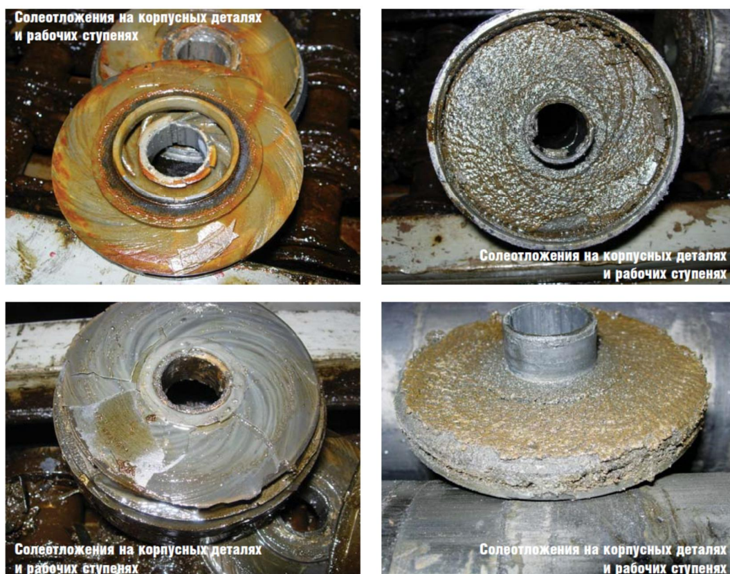
Рисунок 6. Солеотложение на корпусных деталях и рабочих ступенях УЭЦН
