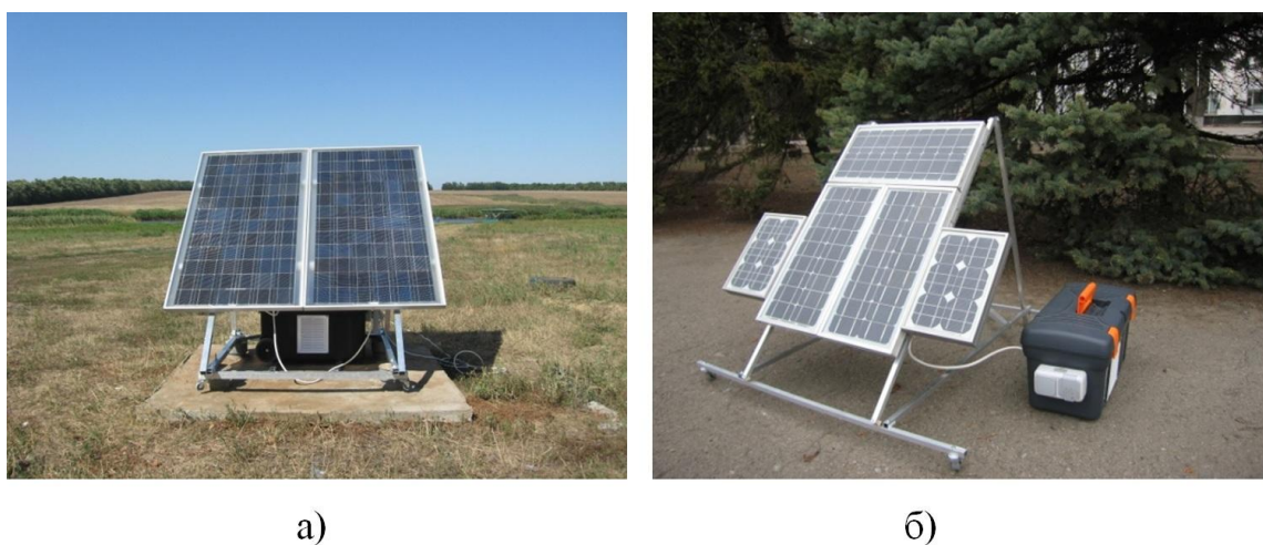
Рисунок 5. Солнечная электростанция для удаленных сельскохозяйственных потребителей (а – с фиксированным положением фотоэлектрической батареи, б – с подвижной фотоэлектрической батареей)
