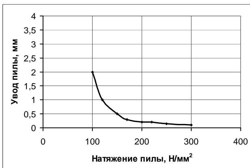
Рисунок 1 Зависимость увода пилы от натяжения для состояния приработанной пилы.
