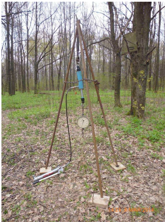
Рисунок 1 - Измерительный комплекс определения усилия на корчевание
