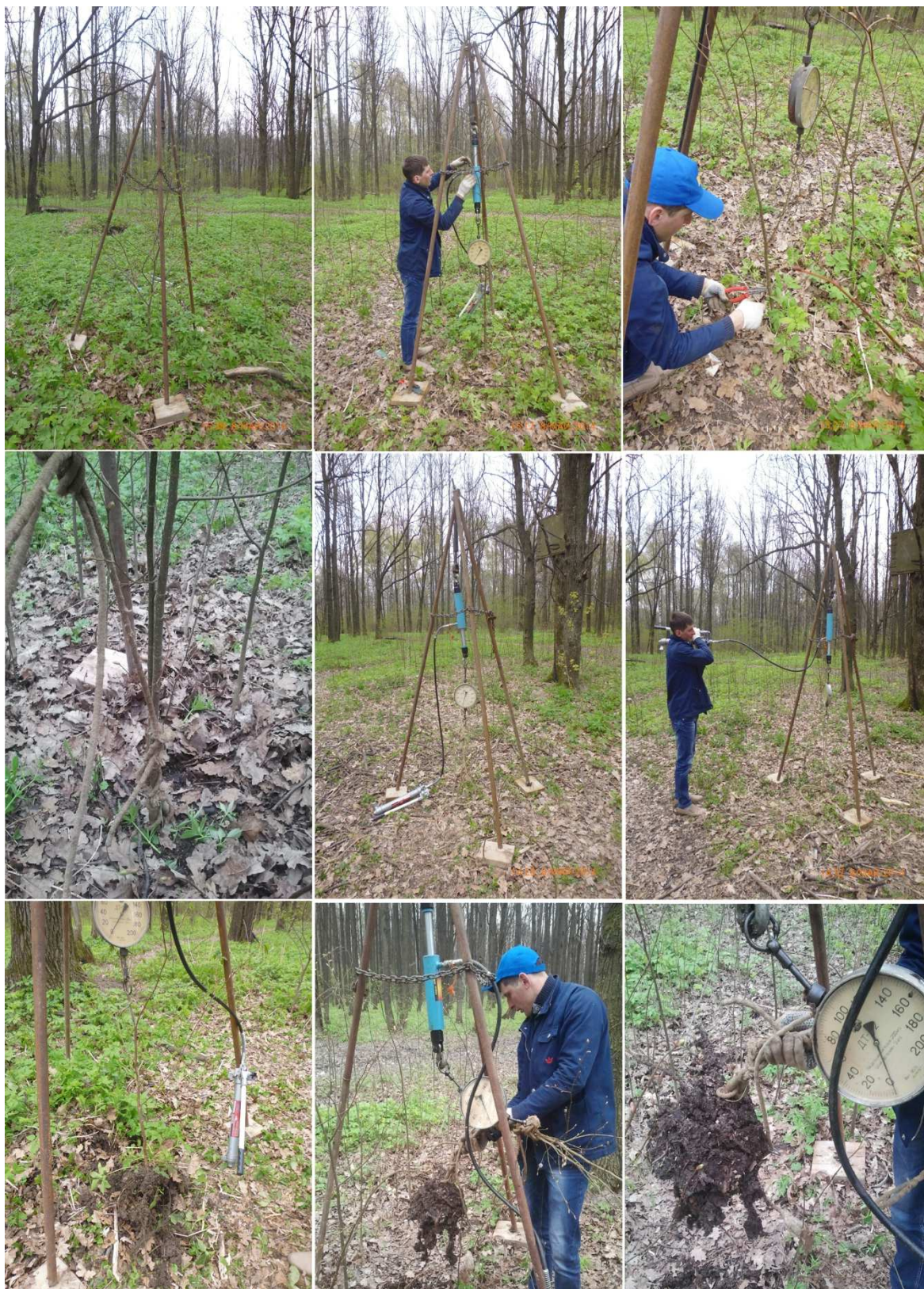
Рисунок 3 – Пошаговые фрагменты фотографий методики экспериментальных измерений усилия на корчевание
