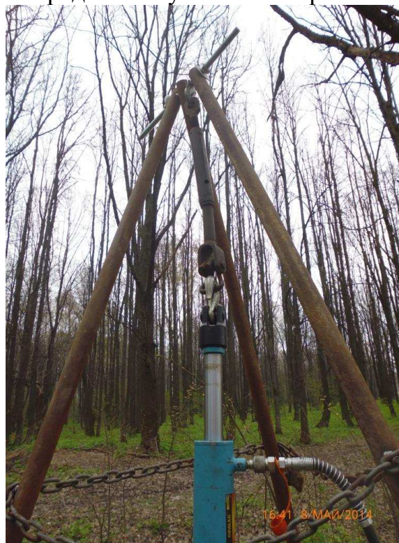
Рисунок 2 - Устройство подвеса измерительного комплекса для определения усилия на корчевание
