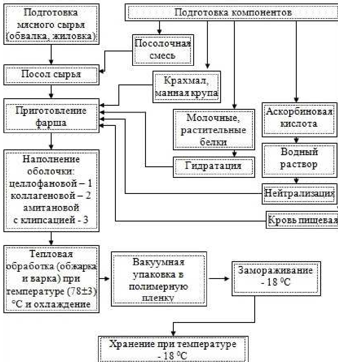
Рисунок 1 – Технологическая схема антианемических колбасок с пролонгированными сроками хранения
