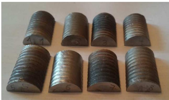
Рисунок 1 – Заготовки металлографических шлифов
